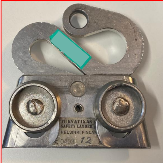
Rungossa on huomattavaa kulumaa
